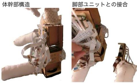
図 10 体幹部と脚部の接合構造
